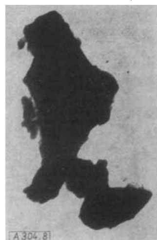
Bild 8 Rohdolomit, elektronenmikroskopisch. Vergr. 36500 1
